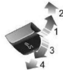
Empuje hacia arriba el interruptor del cristal del techo panorámico hasta la 1ª posición (1) y manténgalo pulsado, el techo panorámico será abierto manualmente de forma inclinada. El movimiento del techo panorámico puede ser detenido en cualquier momento soltando el interruptor.
