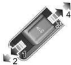
Empuje el interruptor de cristal del techo panorámico hacia atrás hasta la 1ª posición (3) y manténgalo pulsado, el techo solar será abierto manualmente por deslizamiento.
