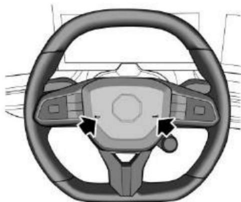
Pulse la zona del interruptor del claxon (como indica la flecha) en el volante para accionar el claxon.
