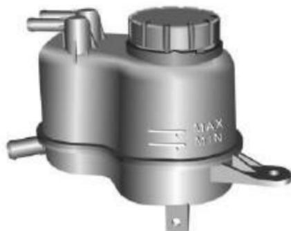
El sistema de refrigeración debe ser revisado semanalmente. Durante la inspección, el vehículo deberá estar estacionado sobre suelo nivelado y el sistema de refrigeración deberá estar en estado frío. Si el nivel de refrigerante está por debajo de la marca "MIN", abra el tapón del depósito de expansión de refrigerante y rellene refrigerante. El nivel de refrigerante no debe ser superior a la marca "MAX".
