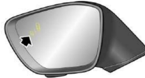
En caso de riesgo de colisión, el indicador luminoso del lugar correspondiente se enciende. En este caso, si la acción de apertura de la puerta continúa, el indicador luminoso parpadeará con una alarma acústica.
