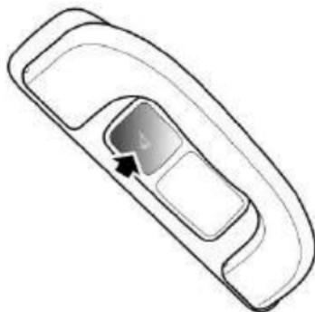
Las luces interiores traseras están situadas en los lados izquierdo y derecho del techo. Pulse el interruptor tal y como indica la flecha para encender las lámparas y vuelva a pulsarlo para apagarlas.
