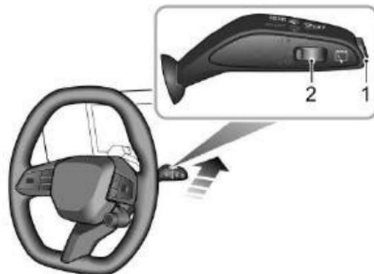
Cuando el interruptor START/STOP está en la posición ACC/ON/RUNNING, los limpiaparabrisas y lavaparabrisas traseros pueden funcionar.
