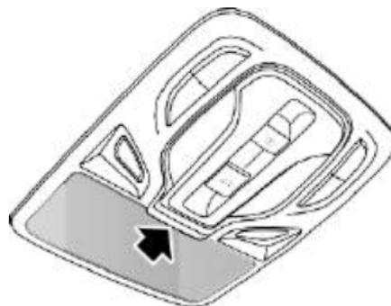
La caja para anteojos está situada en las proximidades de las luces de cortesía delanteras. Pulse el panel (como indica la flecha) para abrir la caja para anteojos. Cierre la caja para anteojos cuando no esté en uso.
