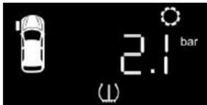
En la interfaz de control de presión de neumáticos, pulse brevemente la rueda selectora situada a la derecha del volante para mostrar la presión de los neumáticos. Pulse brevemente el botón LEFT/RIGHT de la derecha del volante para mostrar el estado de la presión de los neumáticos de las cuatro ruedas en ciclo.
