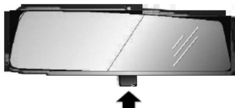
Mueva la palanca situada en la base del espejo retrovisor interior para modificar su ángulo y conseguir así la función antideslumbrante. La visibilidad normal se restablece volviendo a tirar de la palanca.
