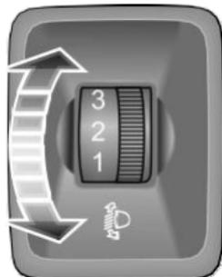
La nivelación de faros puede ajustarse según la siguiente tabla en función de la carga del vehículo.
