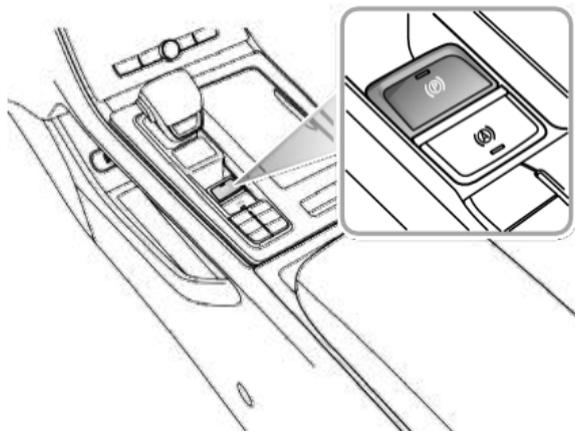
Cuando el vehículo esté estacionado de forma segura, tire del interruptor EPB hacia arriba para aplicar el EPB. Asegúrese de que el interruptor START/STOP esté en estado ON/RUNNING, pise el pedal de freno y pulse el interruptor EPB para liberar el EPB.
