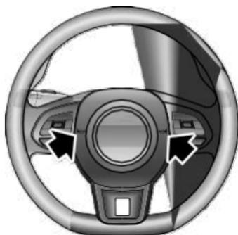
Pulse la zona del interruptor del claxon (como indica la flecha) en el volante para accionar el claxon.
