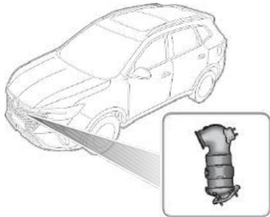
El sistema de escape incorpora un convertidor catalítico, que convierte las emisiones tóxicas del motor en gases menos dañinos para el medio ambiente. El catalizador se daña fácilmente por un uso inadecuado, observe las siguientes precauciones para minimizar la posibilidad de daños accidentales:
