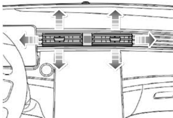
Deslice el botón situado en el centro de las ventilas de lado a lado para abrir o cerrar la ventila. Dirija el flujo de aire moviendo el botón hacia arriba y hacia abajo, o de lado a lado
