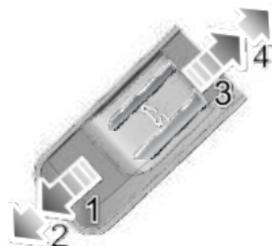
Empuje el interruptor del vidrio del quemacocos hacia atrás hasta la primera posición (como se muestra en la figura 3) y manténgalo pulsado; el quemacocos se abrirá manualmente. El movimiento del quemacocos puede detenerse en cualquier momento soltando el interruptor. Empuje el interruptor del vidrio hacia atrás con fuerza hasta la 2ª posición (4) y luego suéltelo, el quemacocos se abrirá automáticamente hasta el final.
