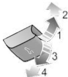
Empuje hacia arriba el interruptor del vidrio del quemacocos hasta la primera posición (1) y manténgalo pulsado, el quemacocos se abrirá manualmente. El movimiento del quemacocos puede detenerse en cualquier momento soltando el interruptor. Empuje hacia arriba el interruptor del vidrio con fuerza hasta la 2ª posición (2) y luego suéltelo, el quemacocos se abrirá automáticamente hasta el final.
