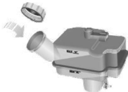
***Nota: El líquido de frenos puede dañar las superficies pintadas. Si accidentalmente derrama el líquido de frenos sobre la superficie pintada, absorba inmediatamente cualquier derrame con un paño absorbente y lave la zona con agua o champú para coches.***
