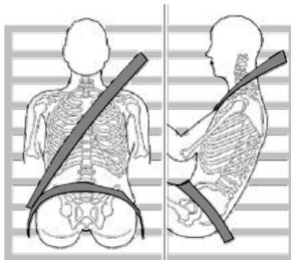
Al usar los cinturones de seguridad, el cinturón de cadera debe estar lo más bajo posible y pegado a las caderas. Nunca cruce el abdomen. Cuando se produce una colisión, el cinturón de cadera puede aplicar fuerza sobre las caderas y reducir la posibilidad de que se mueva por debajo del cinturón de cadera. Si se mueve por debajo del cinturón de cadera, éste aplicará fuerza sobre el abdomen,
