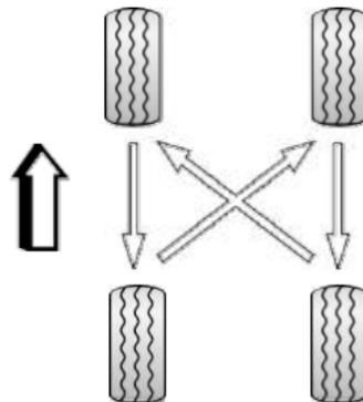
**Nota:** Los neumáticos con dibujo direccional tienen flechas en el lateral para marcar la dirección, y es esencial utilizar el neumático en esta dirección de rotación para asegurar el desempeño de conducción
