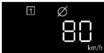
Muestra la velocidad media del vehículo en la conducción actual. Este valor se restablecerá automáticamente cuando el vehículo se apague durante un periodo de tiempo, o
