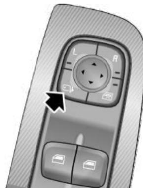
Al desbloquear/bloquear el vehículo, los retrovisores exteriores se desplegarán/plegarán automáticamente. Esta función puede ajustarse en la interfaz correspondiente en "Ajuste del vehículo" en la pantalla de entretenimiento.
