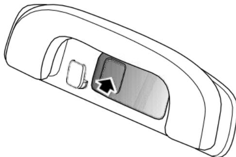
Las luces de cortesía traseras están situadas en los lados izquierdo y derecho del techo. Presione la cubierta de la lámpara como se indica en la flecha para encender las luces de cortesía traseras, y vuelva a presionarla para apagarlas.
