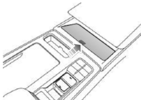
La zona de carga inalámbrica está situada delante del descansabrazos de la consola central; cuando el interruptor de arranque está en la posición ACC/ON/RUNNING, se puede utilizar la función de carga. Coloque la parte posterior del teléfono en el área de carga para la carga inalámbrica.
