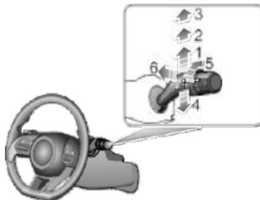
El limpiaparabrisas y el lavaparabrisas sólo funcionan cuando el interruptor START/STOP está encendido. Accione la palanca para seleccionar diferentes velocidades de limpieza::
