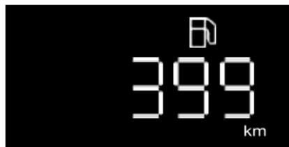
Esta función calcula y muestra automáticamente el kilometraje que puede recorrer el automóvil antes de que se vacíe el depósito de combustible, y este kilometraje cambiará después de cargar.
