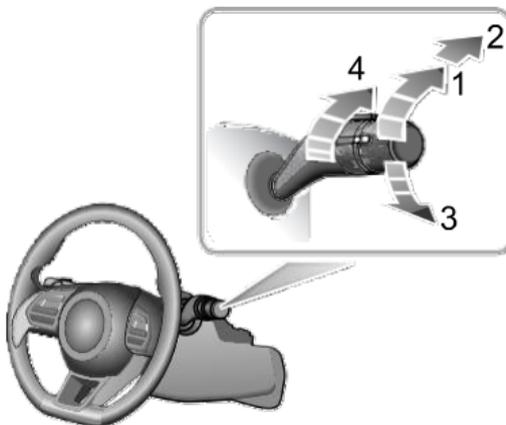
El limpiaparabrisas y el lavaparabrisas traseros sólo funcionan cuando el interruptor START/STOP está en la posición ON. Accione la palanca para seleccionar los diferentes modos de limpieza:
